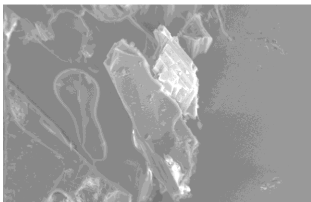
Рис.3 Микроснимок не растворившейся в воде фракции порошка Air-Flow Perio (500x)
